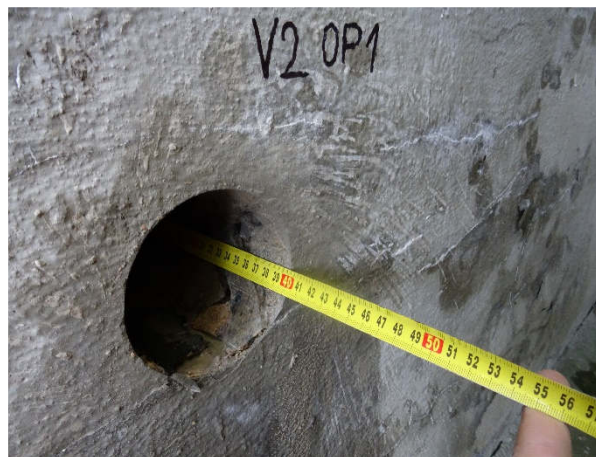
Obr. 21: Změřené délka odtvoru po vývrtu V2..
