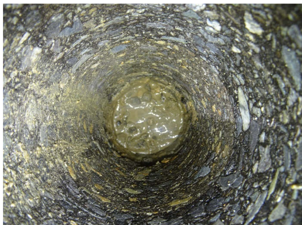
Obr. 34: Vnitřek otvoru vývrtu po odbranén vzorku V5.
