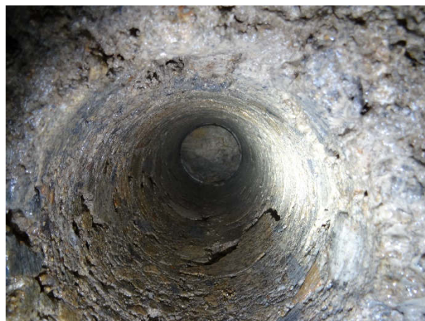
Obr. 23: Vnitřek otvoru po odbranén vzorku V3..
