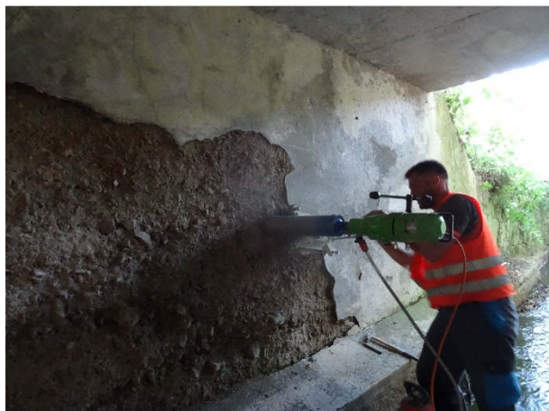
Obr. 14: Provádění vývrtu na Op2 pro odběr vzorku V1.
