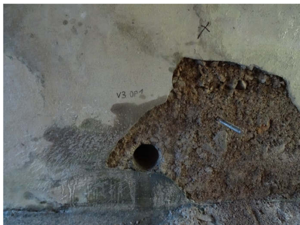
Obr. 22: Otvor po odběru vzorku V3.
