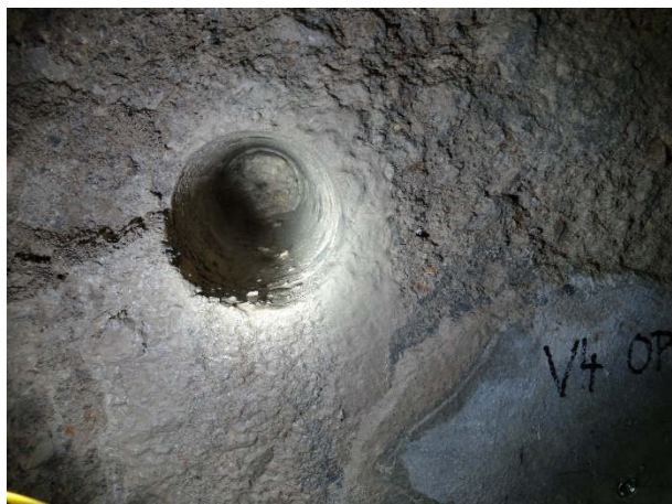
Obr. 26: Vnitřek otvoru po odbranění vzorku V4.
