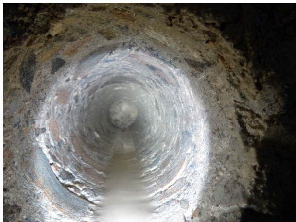
Obr. 16: Vnitřek otvoru po odbranění vzorku V1.
