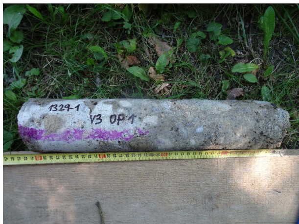
Obr. 30: Vzorek V3 s provedeným fenoltaleinovým testem..
