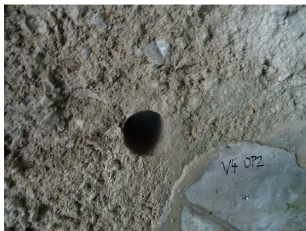
Obr. 25: Otvor po odběru vzorku V4.
