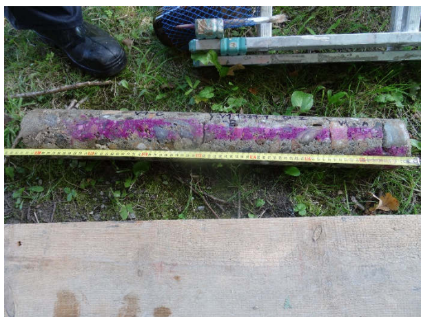
Obr. 28: Vzorek V1 s provedeným fenolftaleinovým testem.
