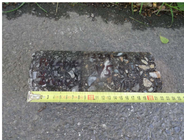
Obr. 35: Odebraný vorek (V5) ze zpevněných vrstev konstrukce vozovky..
