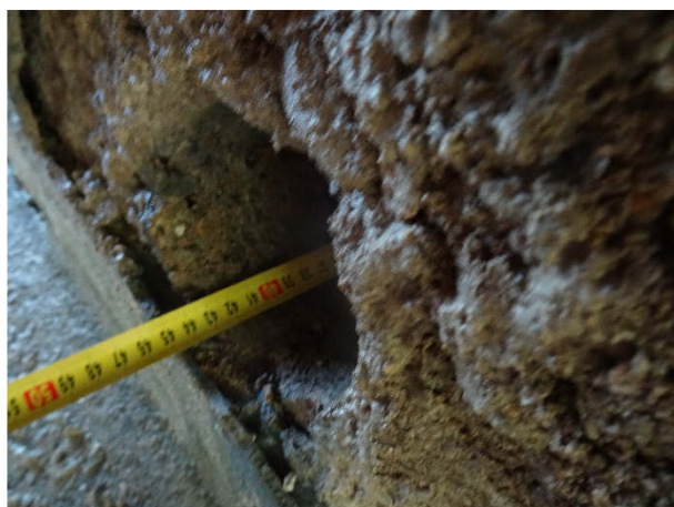
Obr. 24: Změřené délka odtvoru po vývrtu V3..
