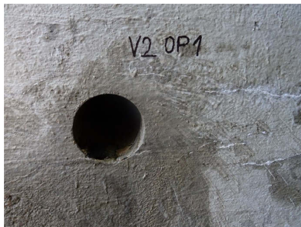
Obr. 19: Otvor po odběru vzorku V2.
