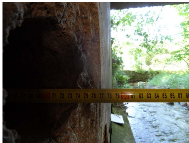
Obr. 17: Změřené délka odtvoru po vývrtu V1.
